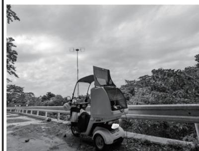
430MHz帯をスイスクワッドアンテナで運用する様子。1.2エレ程度の八木と同等性能でコンパクト。
